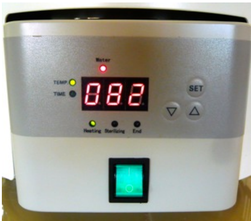
Figura 11: Tablero de control del autoclave
