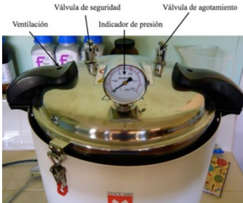
Figura 9: Tapa del autoclave. Antes de encender el autoclave verificar que las válvulas están bajadas.
